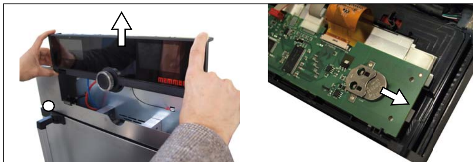
Obr. 25 Vyjmutí lithiové baterie
